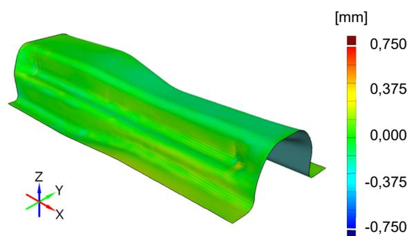
Abweichungen eines kompensiertes Bauteils nach sechs Iterationen durch den Tryout-Manager mit Kontrollpunktverschiebung der B-Splines, Werkstoff: DC04
