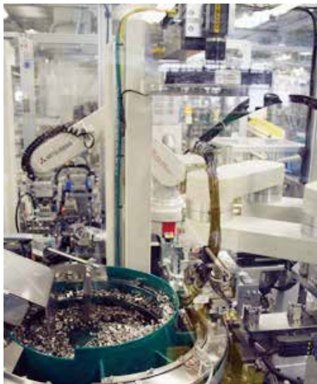
図 可児工場のロボットセル生産システム
