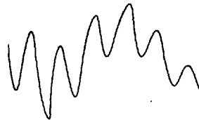
Abb. 22. Zwei übereinandergelagerte Präzessionsschwingungen.
