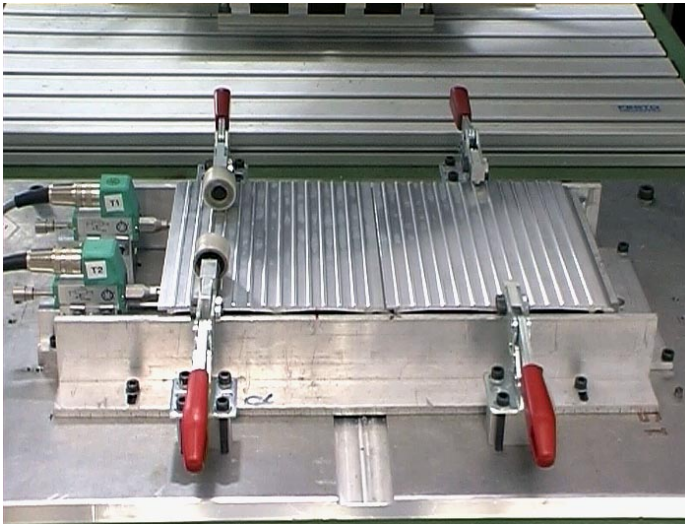
Bild 8.6 Spannvorrichtung mit Erfassung des Bauteilverzugs
