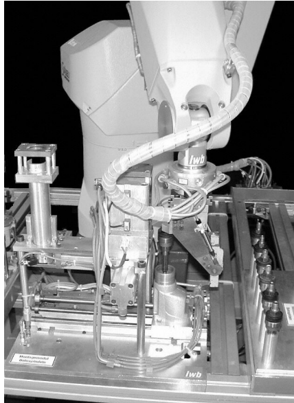
Abbildung 73: Einsetzen der Spindel durch den Roboter
