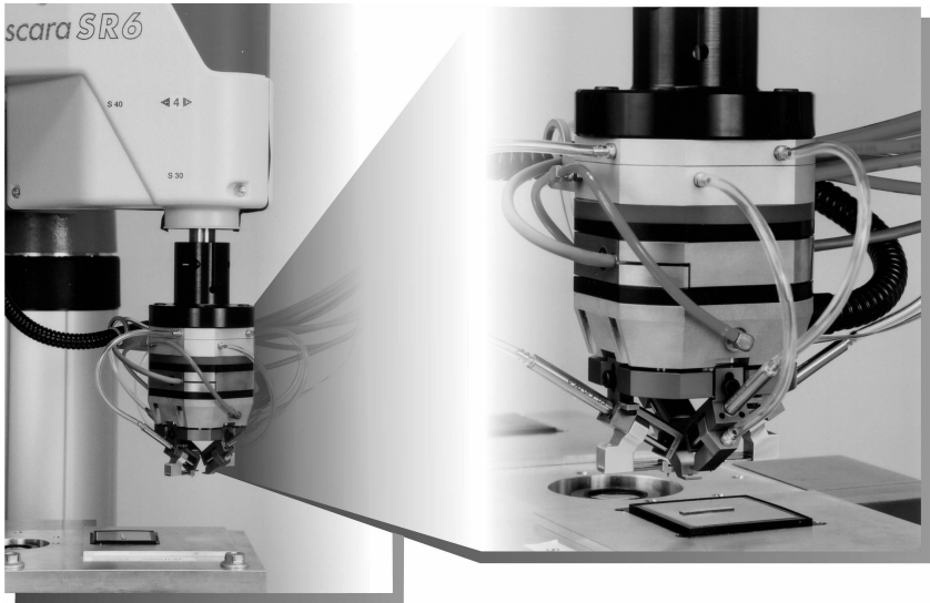
Bild 5.14: Prototyp des flexiblen, feinpositionierbaren Werkzeugsystems an einem Scara-Roboter
