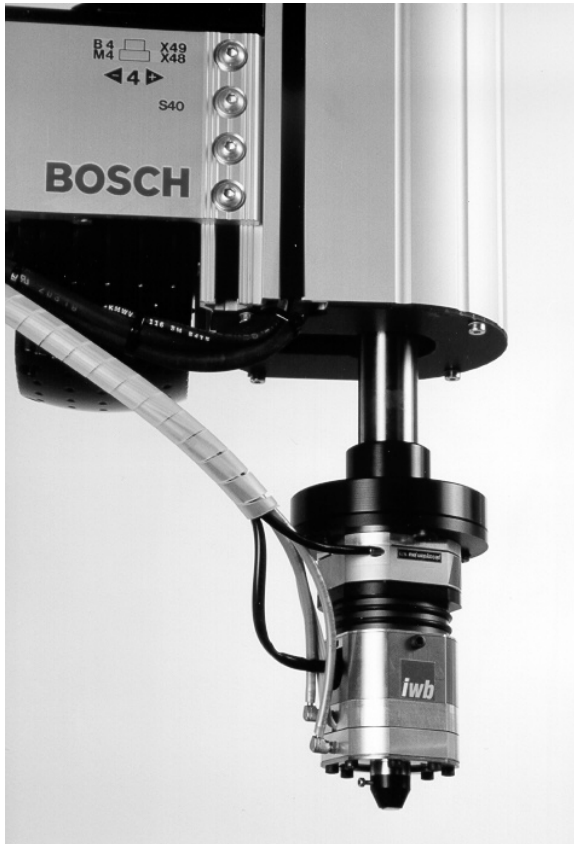
Bild 5.10: Prototyp des Pick-and-Place-Werkzeuges mit integrierter Optik, Kraftsensorik, Piezo-Feinpositionierantrieb und Fokussiermechanismus
