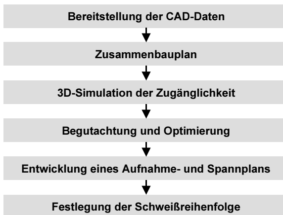
Abbildung 2.9: Ist-Ablauf in der Fertigungsplanung von automatisierten Schweißprozessen
