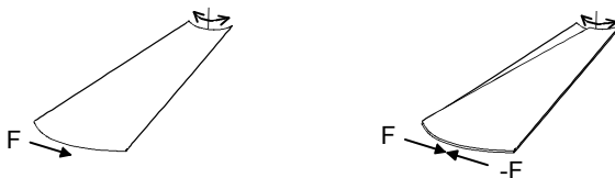
Abb. 8-25: a) Prinzip der Einblattsäge b) Prinzip der Doppelblattsäge
