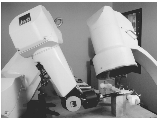
Abb. 7-8: Robotergeführte Positionierung des Kalibrierkörpers im Versuch
