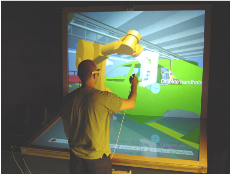
Bild 7-16: Erzeugung eines Roboterprogramms zum Punktschweißen in der VR-Umgebung
