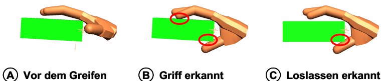
Bild 5-17: Greifen eines Objektes mittels des Datenhandschuhs
