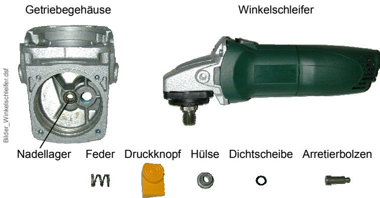
Abbildung 5.1: Winkelschleifer und Bauteile des Getriebegehäuses
