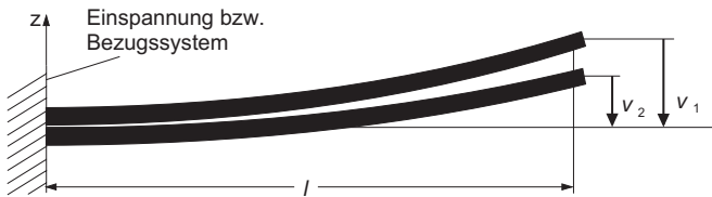
Abbildung 3.4: Baugruppe mit Abweichungen der Bauteile
