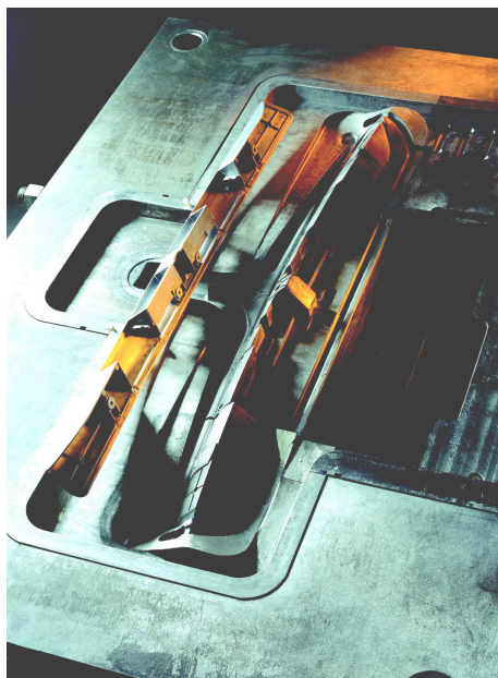
Bild 8-2: Prototypenwerkzeug der Auswerferseite und Prototyp aus \text{AlSi12Cu3}
