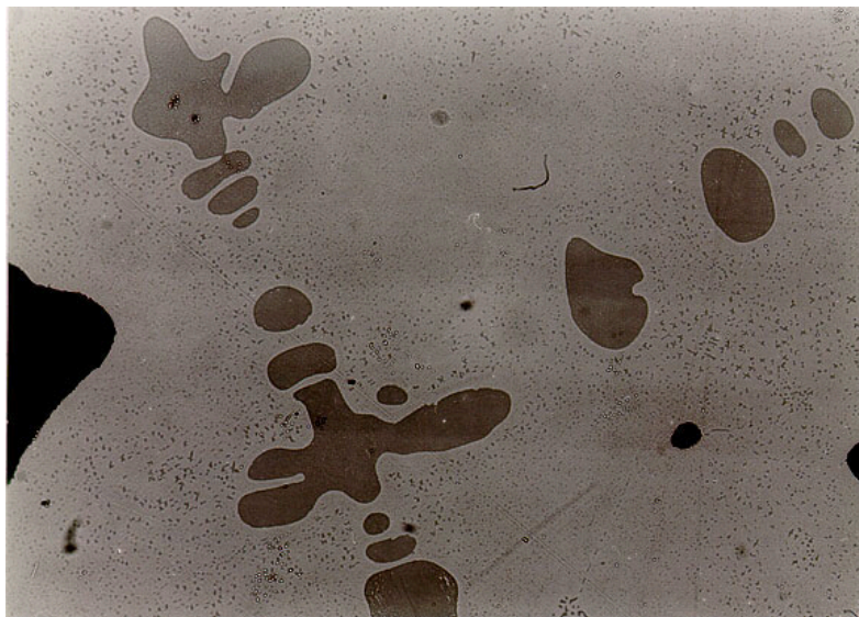
Bild 7-19: Geätzter und polierter Schliff der Aluminiumbronze CuAl10Ni5Fe4 mit Dendridenbildung im Ein- und Austrittsbereich ( V = 200 \times 1,16 )
