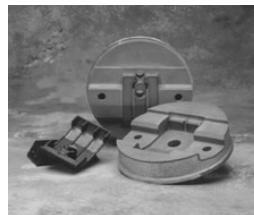
Selektiv-lasergesinterte Formeinsätze aus Polyamid-Kupfer Gemisch
