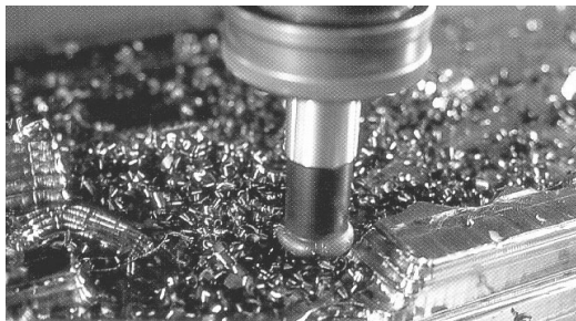
Abbildung 2-14: Verfahrensprinzip des Fräsens
