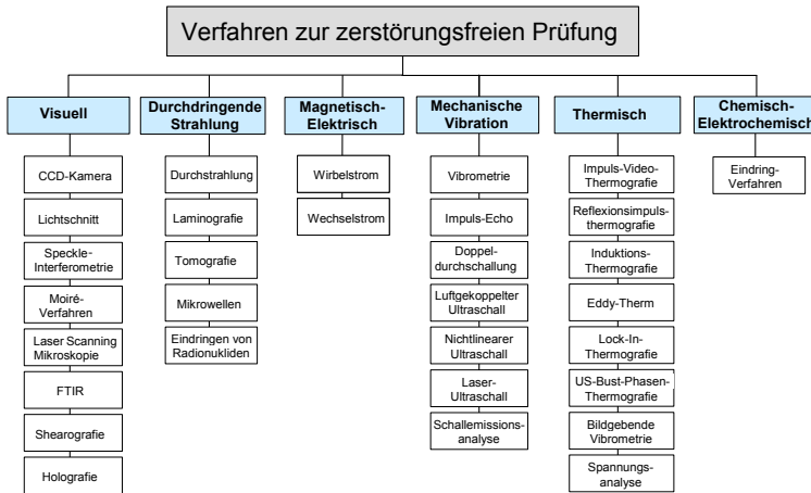
Abbildung 2-12: Überblick über ausgewählte Verfahren zur zerstörungsfreien Bauteilprüfung
