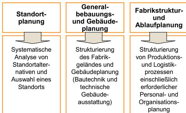
Abbildung 2-2: Gestaltungsfelder der Fabrikplanung (in Anlehnung an GRUNDIG 2006, S. 9)
