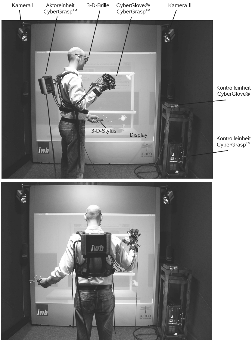
Abbildung 5.15: Realer Aufbau zur Anwendung des Gesamtsystems Ve^2 für die IMS
