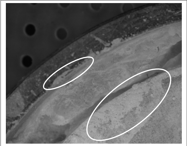
Abbildung 32: Randaufwüchse beim Dispensieren von Bariumchlorid bei einer Nutbreite von 3 mm
