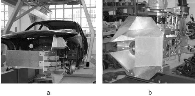
Abbildung 9-1: a) Messstation am Fahrzeug, b) Referenzpyramide am Endeffektor
