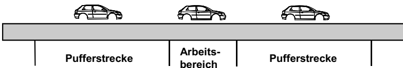
Abbildung 1-1: Gestaltung von Fließmontagelinien in der Automobilindustrie aufgrund getakteter Automatisierungsanlagen
