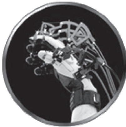
Abbildung 3-20: Datenhandschuh CyberGlove® mit Exoskelett CyberGrasp™ für die Erfassung von 22 Freiheitsgraden der Hand mit Krafterückgabe auf die Finger des Benutzers (Quelle: Immersion Corporation)
