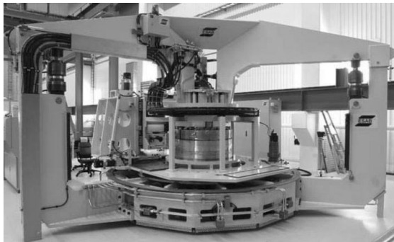
Abbildung 14: Anlage zum Rührreibschweißen von Behältern für Nuklearabfall (CEDERQVIST 2006)
