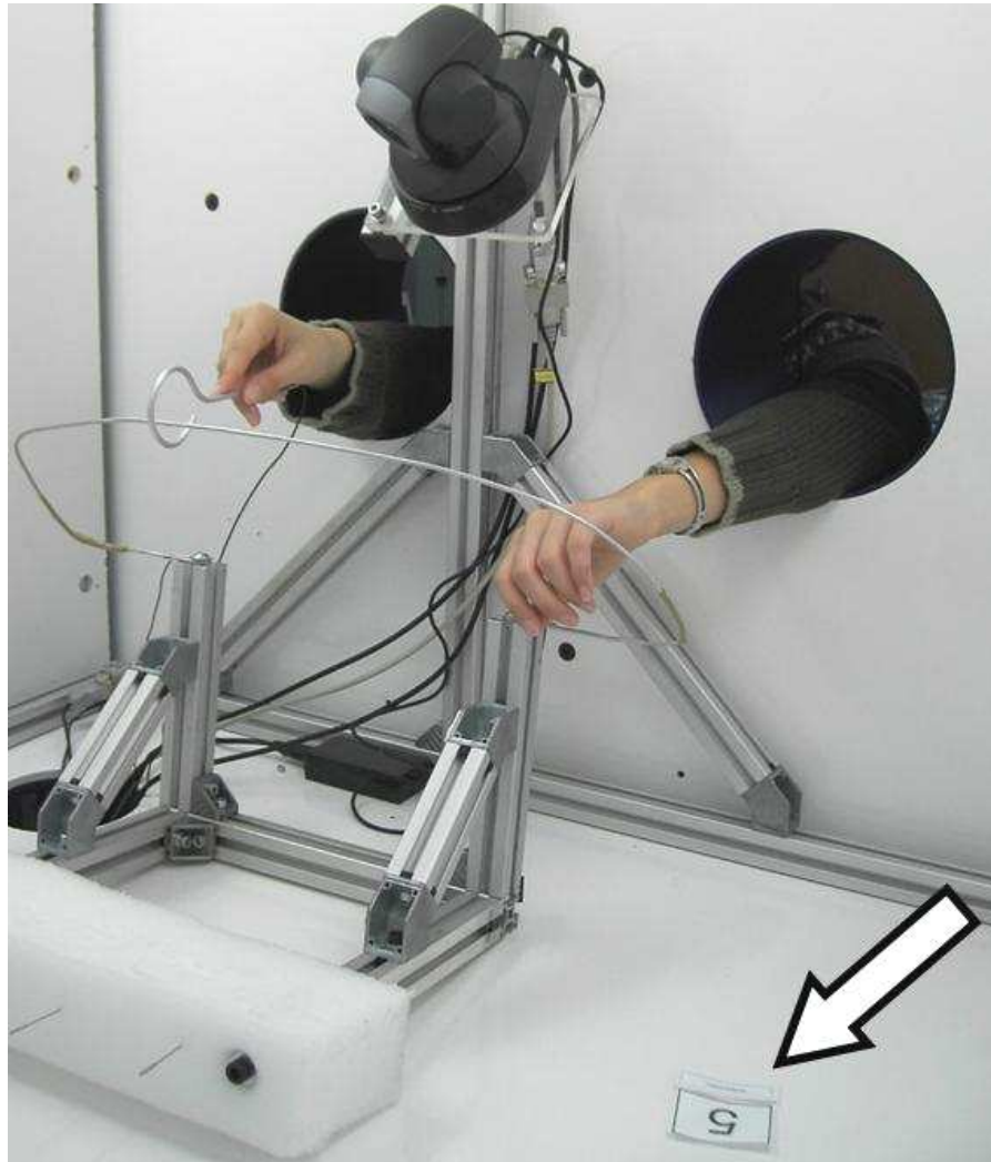
Abbildung 27: Versuchsaufbau für Aufgabe 2 „Heißer-Draht-Spiel“. Unten rechts ist ein Beispiel für einen Anbringungsort der Schilder mit Zahl und Text für Aufgabe 1 zu sehen (siehe Pfeil)
