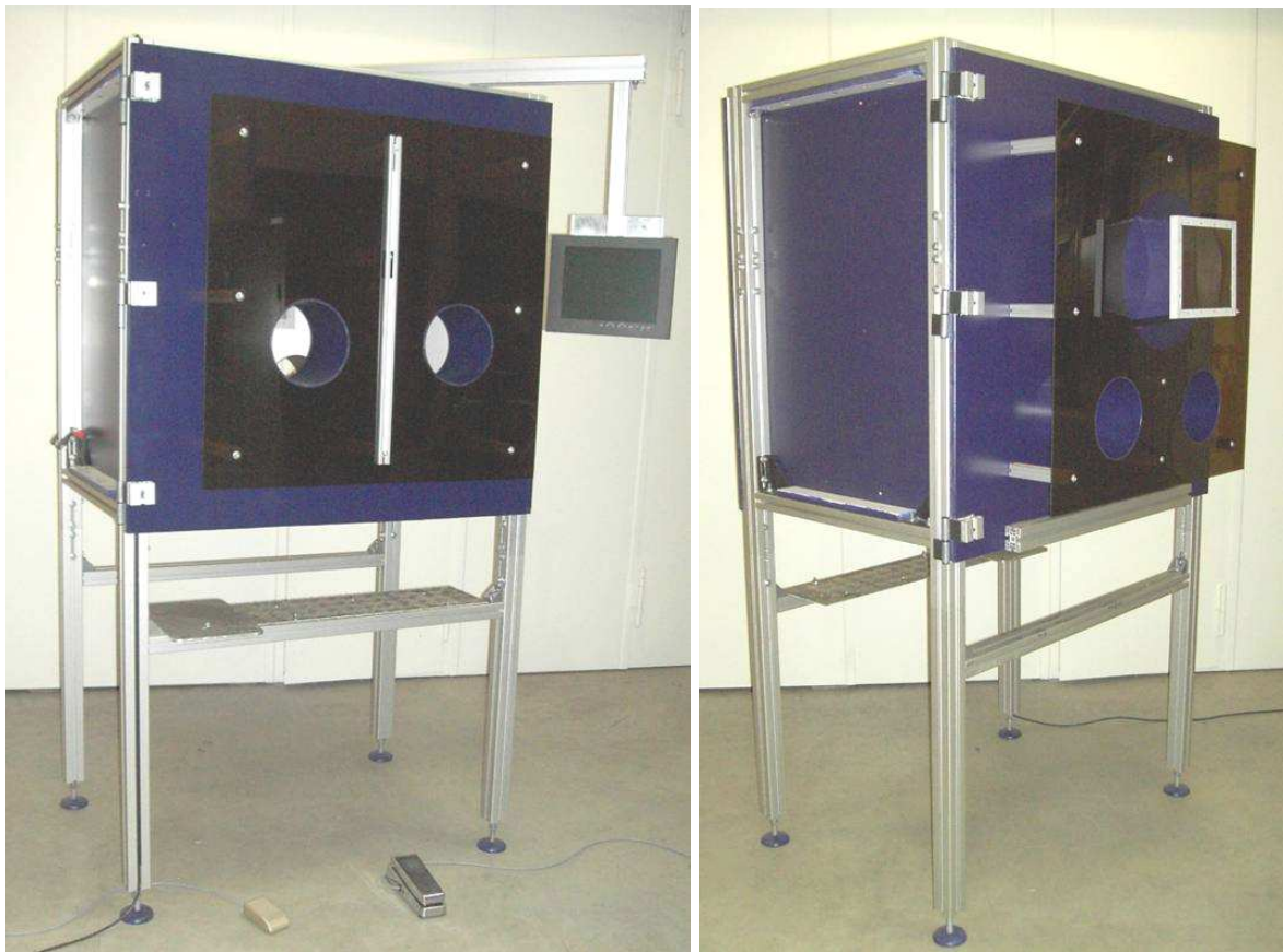
Abbildung 20: Vorder- und Rückseite des Modells einer Heißen Zelle mit Imitat des Bleiglasfensters auf der einen und Versuchsfeld auf der anderen Seite
