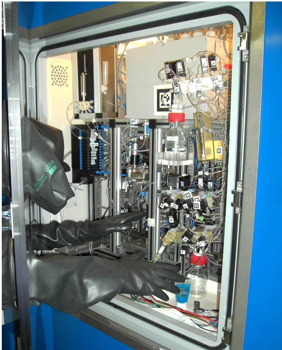
Abbildung 9: Produktionsanlage zur Herstellung von Radioisotopen in einer Heißen Zelle. Im Vordergrund sind die Handschuhe an der geöffneten Türe der Heißen Zelle zu sehen
