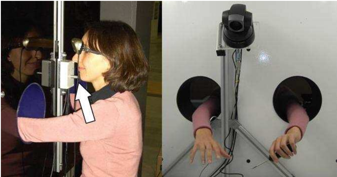
Abbildung 30: Prototyp des Kamerasystems mit Kinnjoystick (links, siehe Pfeil) und PTZ-Kamera im Inneren des Modells einer Heißen Zelle (rechts)
