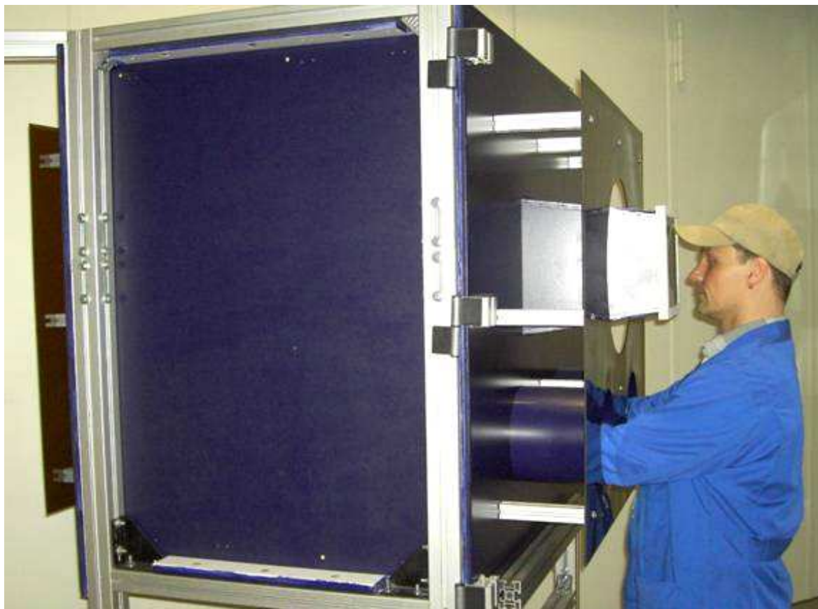
Abbildung 21: Modell der Heißen Zelle. Der sich nach innen aufweitende Schacht mit Plexiglasabdeckung imitiert das dicke Bleiglasfenster mit Brechungseffekt
