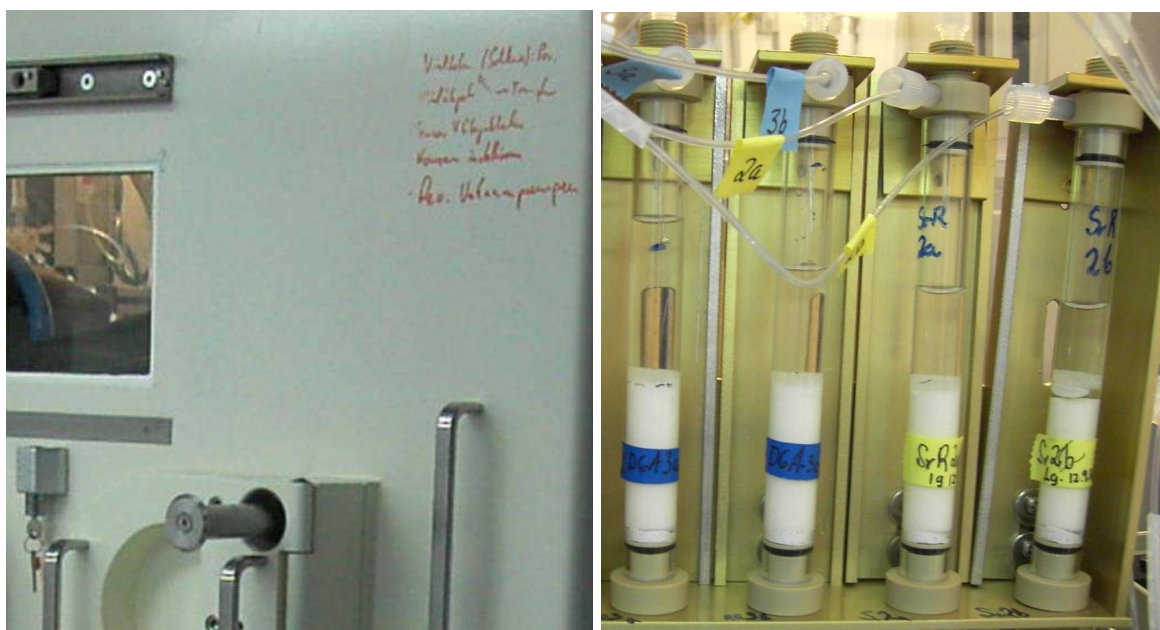
Abbildung 14: Außenansicht einer Heißen Zelle. Teilweise werden die Informationen auf die Wand der Heißen Zelle (links), auf Klebestreifen oder direkt auf die Komponenten wie die Chromatographiesäulen geschrieben (beides rechts).
