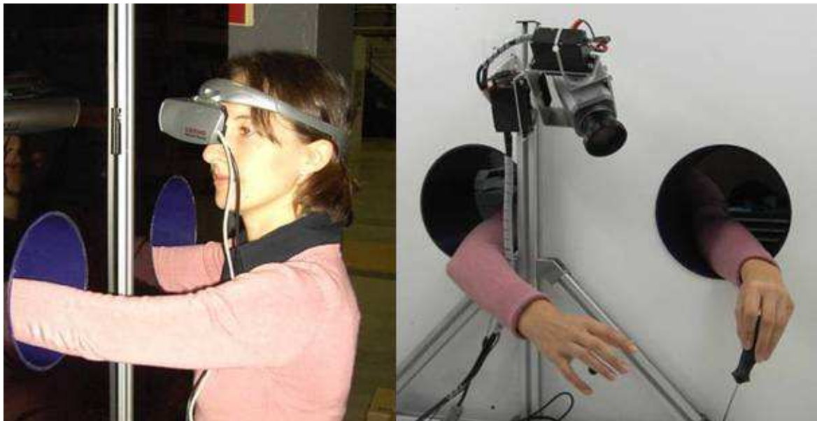
Abbildung 32: Head-Tracking-Ansatz: Die Kamera (rechts) wird von Servomotoren bewegt, die von einem in der Videobrille (links) integrierten Gyro-Tracker gesteuert werden
