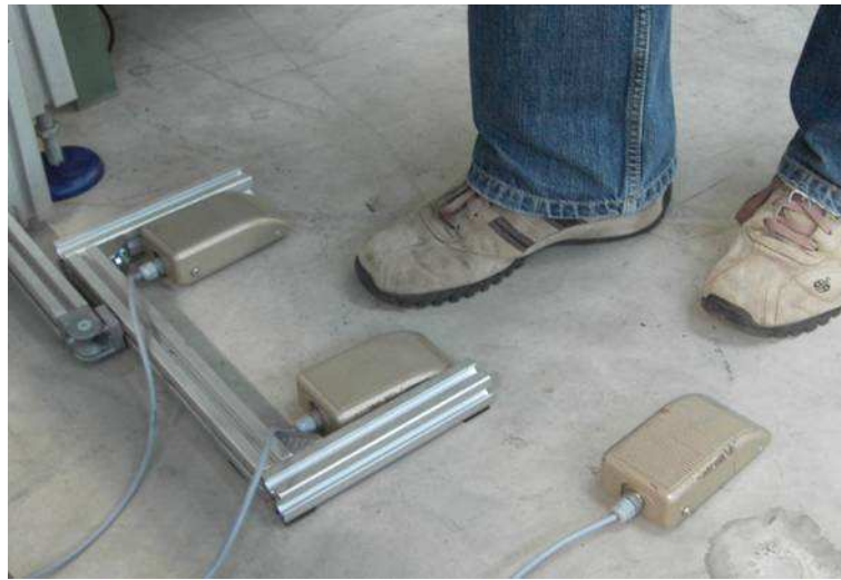
Abbildung 33: Anordnungskonzept der Fußtaster für die Zoom-Steuerung mit einem Rahmen aus Alu-Profilen. Mit dem einzelnen Taster (im Bild rechts) kann die Kamera in die Grundstellung zurückgesetzt werden.
