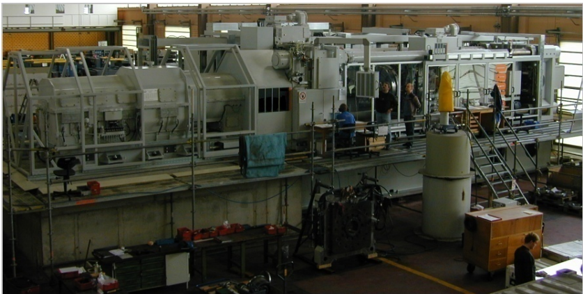
Abbildung 7.1: Reibschweißanlage zur Herstellung von Flugzeugtriebwerken
