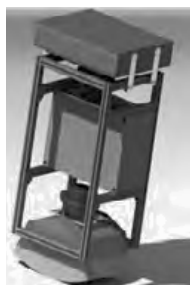
Konzept Doppel-End-Effektor zum Absortieren und Legen
