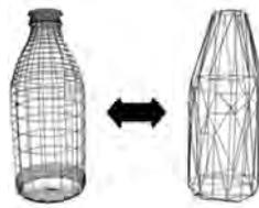
Abbildung 35: Schematische Zuordnung eines graphischen Modells (links) mit dem zugehörigen konvexen Kollisionskörper (rechts)
