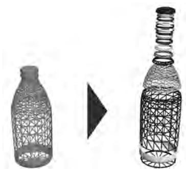
*Abbildung 37: Konvexe Zerlegung (rechts) eines ursprünglich konkaven Geometriemodells einer Flasche (links)*
