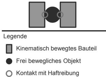
*Abbildung 48: Schematische Kontaktsituation zwischen einem Greifer und einem frei beweglichen Bauteil auf der Basis der aus der Haftreibung resultierenden Kontaktkräfte zwischen den Objekten*
