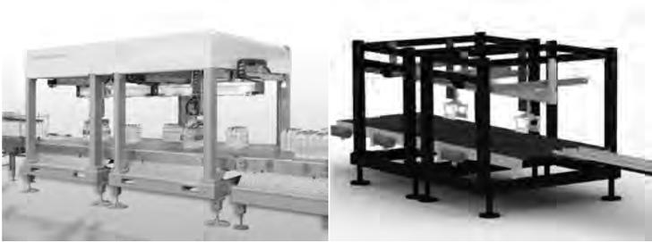
*Abbildung 67: Übersicht der fokussierten Verarbeitungsstation zur Gruppierung von Flaschengebinden in Anlehnung an KRONES (2011)*
