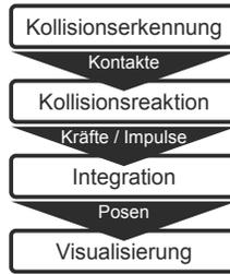
*Abbildung 9: Die drei Phasen der Physiksimulation mit anschließender Visualisierung durch Übertragung der neuen Posen in Anlehnung an EBERLY (2004)*
