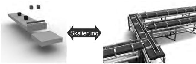
*Abbildung 70: Reichweite der Skalierbarkeit in der Modelldetaillierung von einer einfachen Repräsentation (links) bis hin zu dem präzisen Abbild einer realen Produktionsanlage (rechts)*
