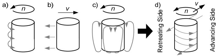
Abbildung 2-5: Komponenten des Werkstoffflusses: a) Rotation, b) Translation c) Wirbel, d) Kombination (nach DUBOURG & DACHEUX 2006)
