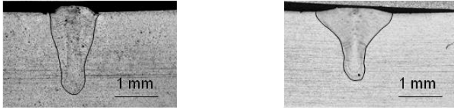
Abbildung 55: Nahtquerschnitt eines Tiefschweißprozesses mit 96 % Ar + 4 % CO 2 (links) und mit 100 % Ar (rechts); Parameter: X6CrNiTi18-10 ( a_i klein), Faserlaser mit P_L = 2 kW, v = 3 m/min, r_s = 400 \mu m, \alpha_1 = 18^\circ schleppend
