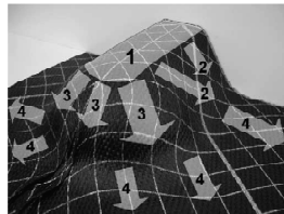
Abbildung 45: Mehrstufige Drapierstrategie an einem Beispielbauteil (HANCOCK & POTTER 2006)
