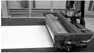
Abbildung 9: PREBLADE-Endeffektor zur automatisierten Herstellung von Rotorblättern (WORTHMANN AUTOMATION GMBH 2011)
