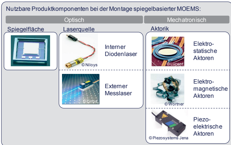
Bild 6-2: Relevante Komponenten bei der mechatronischen Montage mikrooptischer Spiegelsysteme
