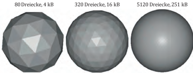
Abbildung 5: Schematische Darstellung eines triangulierten 3D-CAD-Modells am Beispiel einer Kugel (in Anlehnung an KADDAR (2010))
