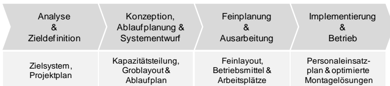
Abbildung 15: Ablauf und Kernergebnisse der Montageplanung
