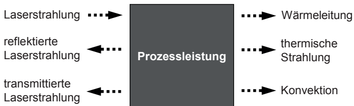
Abbildung 9: Schematische Darstellung der Leistungsbilanz der Strahl-Stoff-Wechselwirkung
