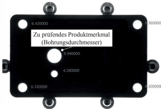
Abbildung 47: Ergebnis der automatisierten Qualitätsprüfung des Getriebegehäuses
