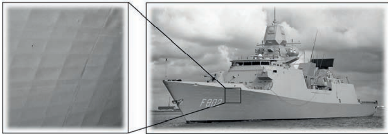
Abbildung 2: Schweißverzugsproblematik bei der Fregatte Hr. Ms. De Zeven Provinciën (Stapellauf April 2000); innenliegende Quer- und Längsstreben zeichnen sich schachbrettartig auf der gesamten Außenhülle ab (links); Resultat: erhöhte(r) Radarsignatur und Strömungswiderstand [VAN DER AA 2007, S. 2]
