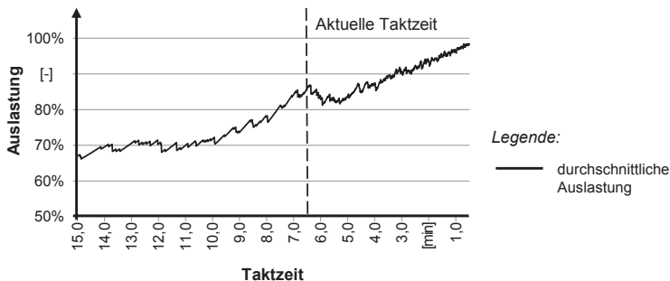
Abbildung 51: Verlauf der Auslastungskurve in Abhängigkeit der Taktzeit bei fester Zuordnung der Arbeitsinhalte über das gesamte Band
