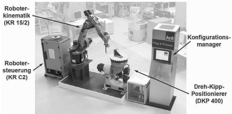
Abbildung 48: Versuchsstand des Referenzszenarios „Roboterbasiertes MIG/MAG Schweißen“ (KRUG 2013)
