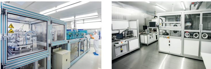
Abbildung 30: iwb-Labor zur Elektrodenherstellung im Reinraum (links) und zur Zellmontage im Trockenraum (rechts)
