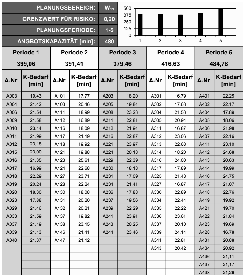
Abbildung 87: Auftrags-Planungstabelle mit den je Periode abzuarbeitenden Aufträgen sowie der Darstellung des Belastungsdiagramms des betrachteten Planungsbereichs
