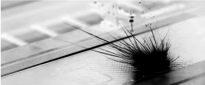
Abbildung 5.3: Aufnahme des Trennprozesses in Tonwert-Umkehrung unter Veranschaulichung emporgeschleudelter, leuchtender Werkstofffragmente als schwarz erkennbare Spuren
