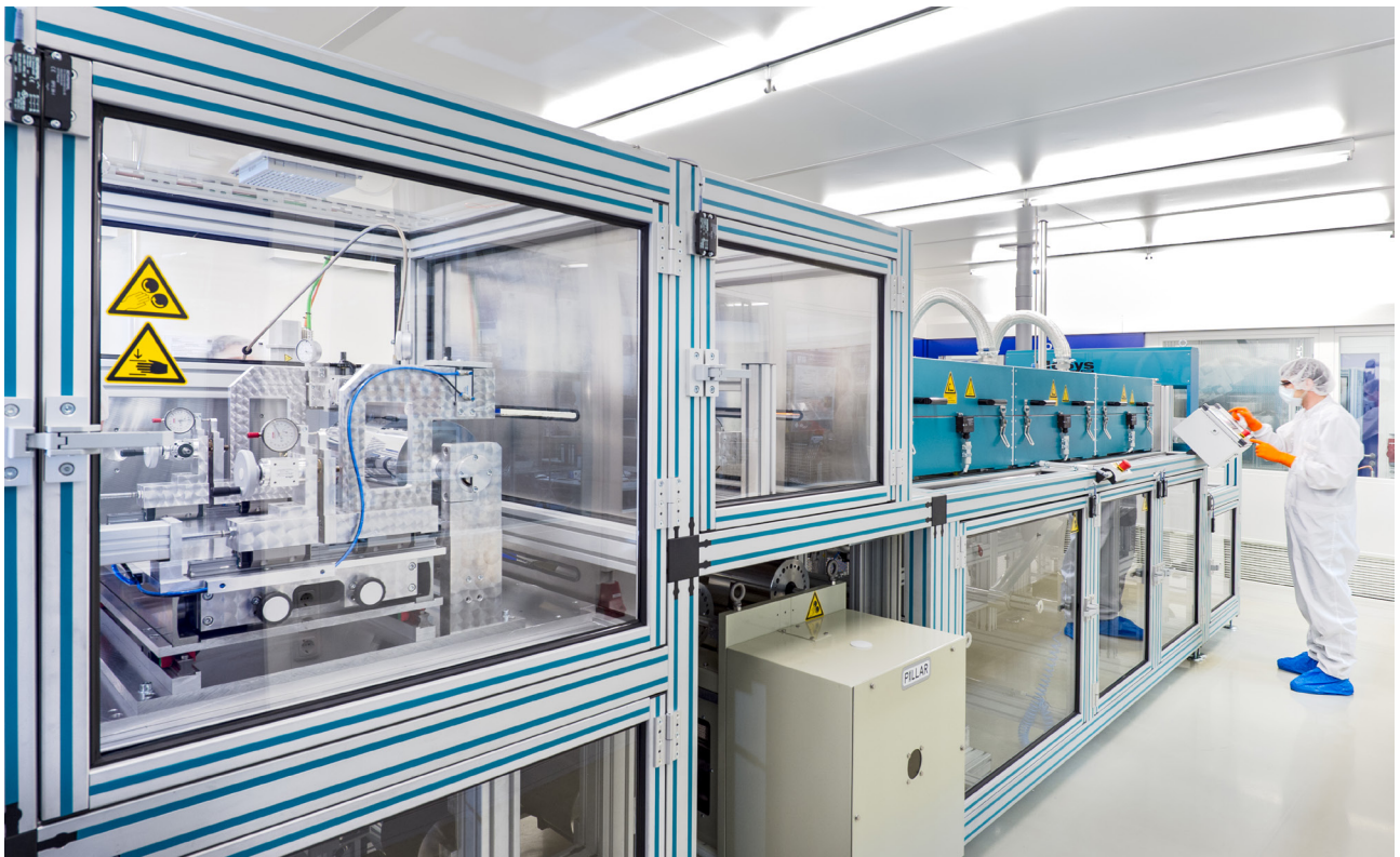
Teil der ersten vollständigen Forschungsproduktionslinie für Lithium-Ionen-Zellen in der Versuchshalle des iwB
