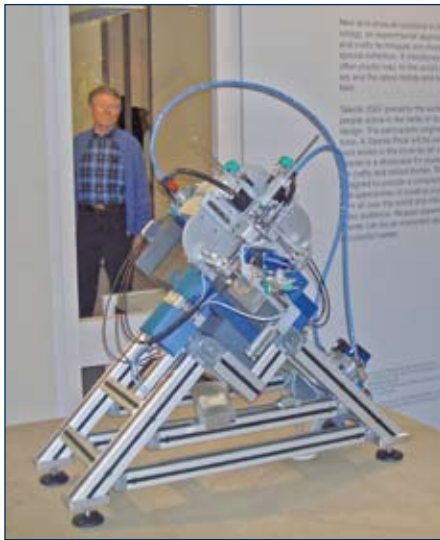
Abb. 1: Das am iwb Anwenderzentrum Augsburg entwickelte formflexible Werkzeug für den wirtschaftlichen Einsatz im Spritzguss
