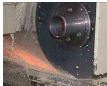
Abb. 2: Experimentelle Untersuchung zum Verfahren Schleifhärten
