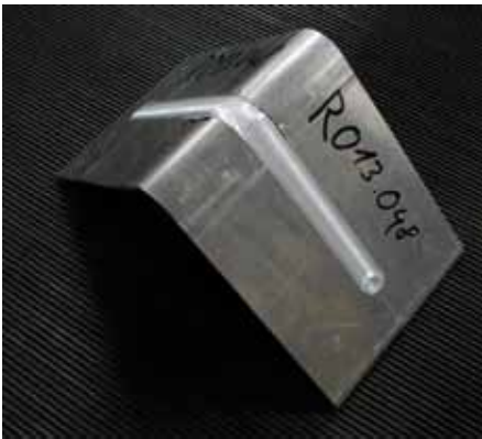
Abb. 2: Geschweißtes Aluminiumblech mit einem Außenradius von 14,5 mm
