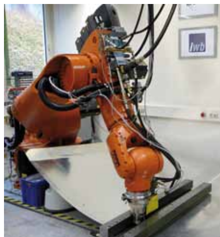
Abb. 1: Rührreißschweißen eines Flugzeug-Rumpfsegmentes mit dem Roboter
