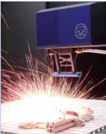
Abb. 3: Remote-Laserstrahlschneiden mit dem Scanner
