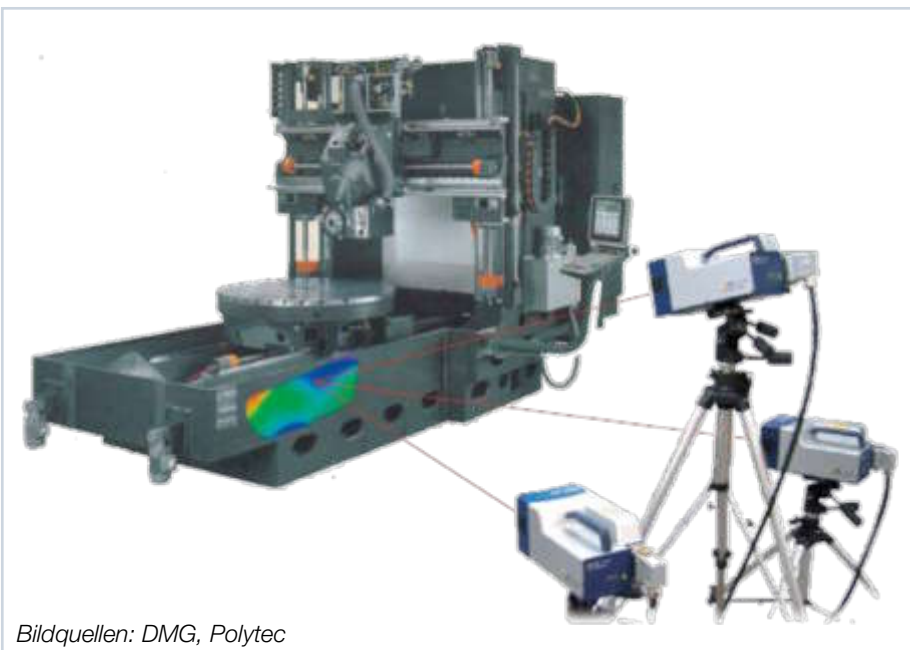
Abb. 2: Laser-Doppler-Vibrometrie zur Vermessung von technischen Systemen
