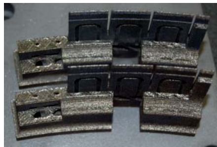
Abb. 2: Generativ gefertigte Formeinsätze aus Werkzeugstahl
