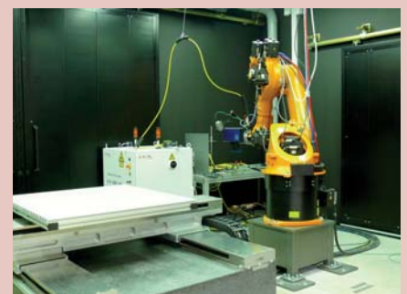
Fertigungszelle zum Laserschneiden und -schweißen
