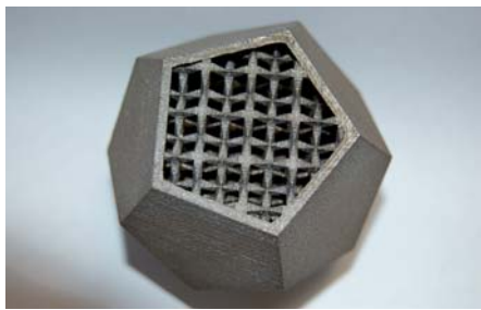
Generativ gefertigtes Bauteil mit inneren Strukturen aus Werkzeugstahl 1.2709
