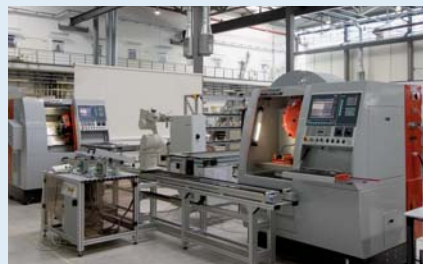
Festo FMS-System mit RFID-Aufbau
