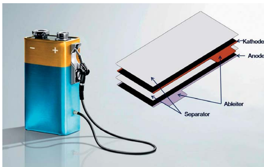
Die Zapsäule der Zukunft (links, Quelle: Volkswagen AG) und der Aufbau einer Lithium-Ionen-Einzelzelle (rechts)
