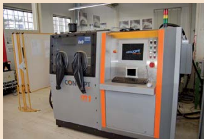
Metallverarbeitende, generative Fertigungsanlage (ConceptLaser M1)
