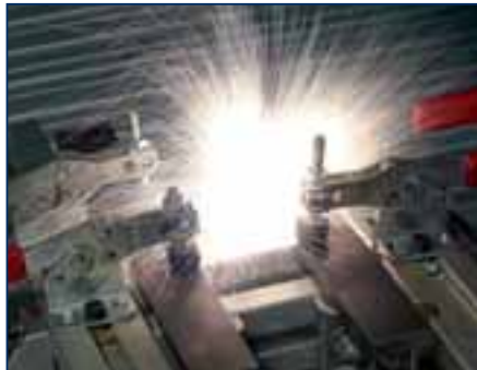
Remote-Laserstrahl-Abtragsschneiden mit einem Single-Mode-Faserlaser an Edelstahl
