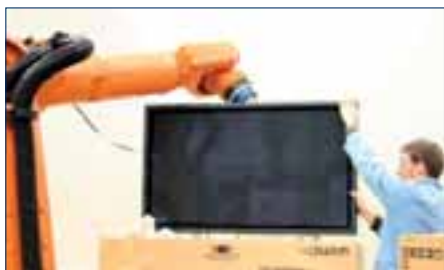
Verpackung von Großbildfernsehern mittels Mensch-Roboter-Kooperation (Fotomontage) © CustomPacker / iw b
