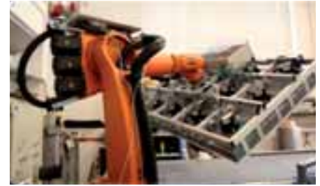
Abb. 2: Automatisiertes Greifsystem zur Handhabung konturvarianter technischer Textilien
