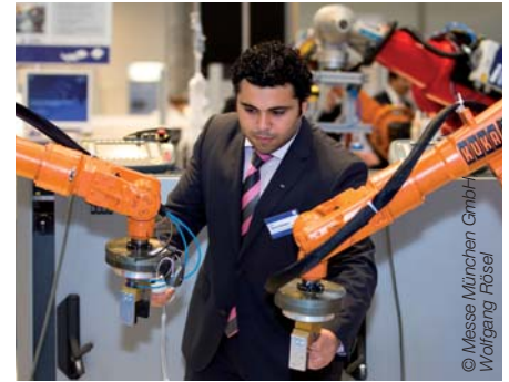
Abb. 1: Sherif Zaidan demonstriert die werkstückbasierte Programmierung kooperierender Roboter
