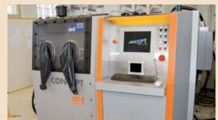
Metallverarbeitende, generative Fertigungsanlage (Concept Laser M1)
