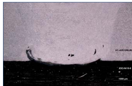
Abb. 3: Mischverbindung Al-Guss (oben) und Edelstahl
