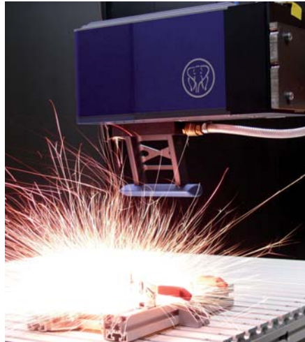
Remote-Laserstrahlschneiden von Edelstahl (Foto: J. Musiol)
