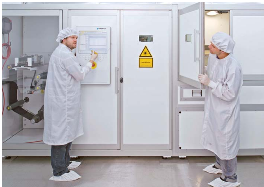
Anlage zum laserstrahlbasierten Elektrodenzuschnitt (Foto: Andreas Heddergott/TUM)
