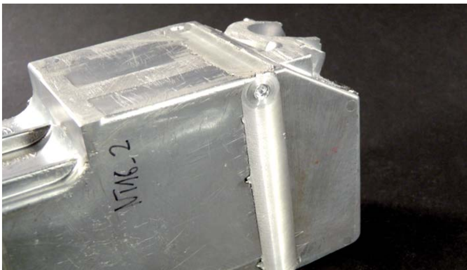
Narkosemitteltank aus Aluminiumdruckguss
